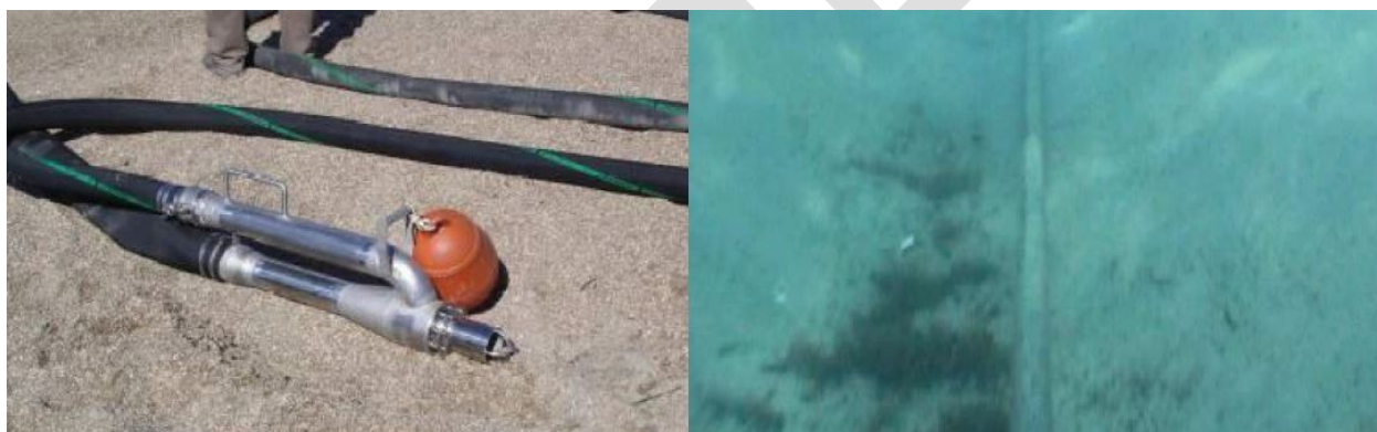
Figure 11 : « Jet sledge » de type WORM pour les eaux très peu profondes (à gauche) et type de tranchée générée (à droite)
